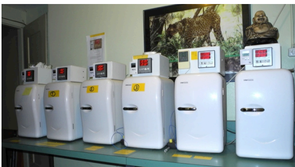
Fig.3. Brutschrank Typ: Spezialanfertigung mit programmierbarem Programmregler. (Temperatursteuerung im Bereich +/- 0,5°C)
